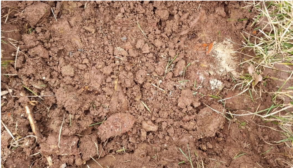
Abbildung 5: SCH 1, Freigelegter Boden mit Fremdbestandteilen Ziegelreste, Kalkstein und Schieferstücke
